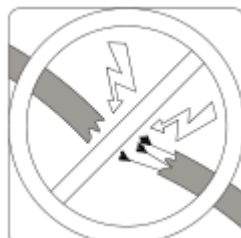
Verificar fios danificados
